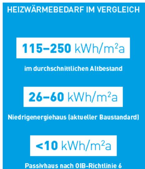
**Abbildung 22: Heizwärmebedarf im Vergleich, Faktencheck Nachhaltiges Bauen**
